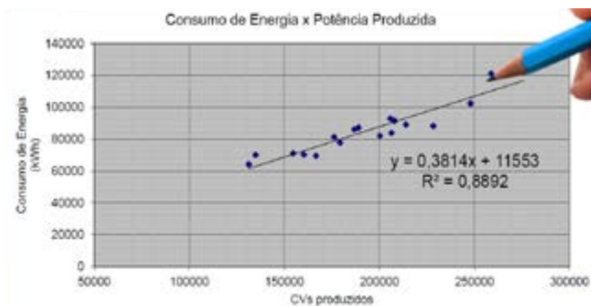
Fig. A3 – Gráfico de dispersão do cálculo do coeficiente de correlação linear entre o consumo de energia da Fábrica VII e a potência produzida na unidade.
